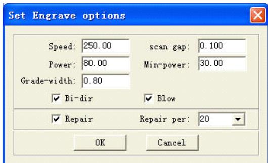
Скорость(Speed): скорость гравировки по Оси X.
