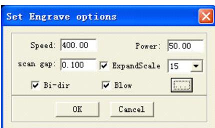
Скорость(Speed): скорость гравировки по Оси X.
