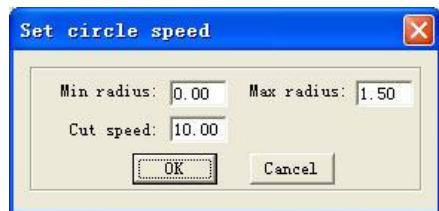
Когда радиус круга находится в диапазоне между Минимальным радиусом «MIN radius» и максимальным радиусом «Max radius», скорость резки будет автоматически изменена на число Скорость резки «Cut Speed».
