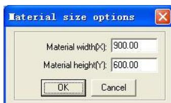
Ширина материала(X) (Material width(X)): это - ширина рабочей части (не может быть больше ширина рабочего стола).
