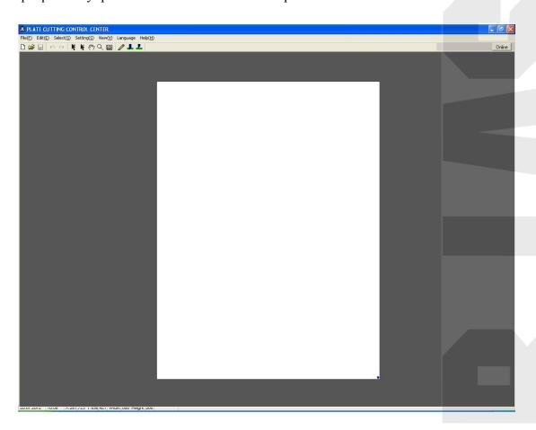
2. В настройках сетевого подключения компьютера введите ір-адрес 192.168.0.123, маску подсети 255.255.255.0 (ір адрес плоттера — 192.168.0.100). Подключите плоттер к сети 220В и соедините его с сетевой картой компьютера при помощи Ethernet кабеля из комплекта, в программе нажмите кнопку "Online" (верхний правый угол), чтобы установить соединение. После этого Вы увидите окно управления плоттером.
