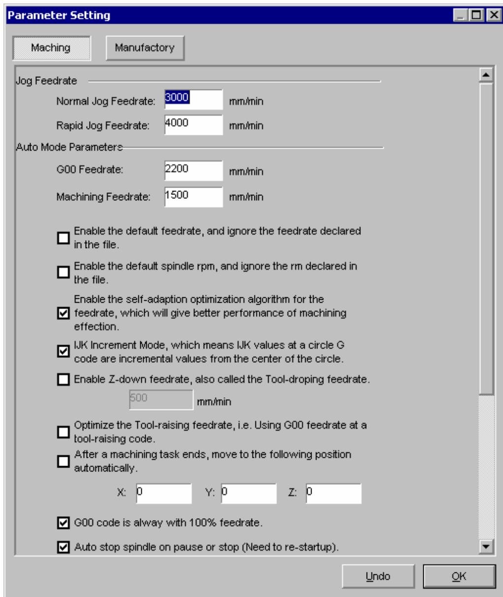
Jog Feedrate (скорость подачи в ручном режиме): это поле включает два значения: Normal Jog Feedrate (нормальная скорость подачи) и Rapid Jog Feedrate (ускоренная подача); с помощью этих двух значений устанавливается скорость подачи в ручном режиме управления.
