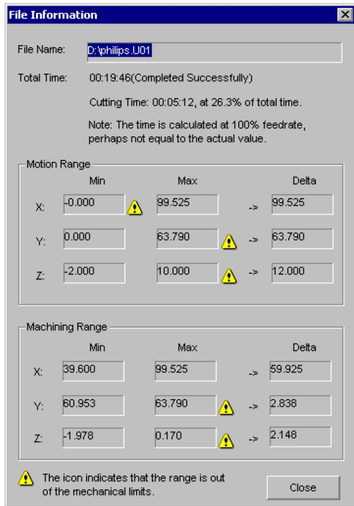
В этом окне отображаются статистические данные процедуры обработки заготовки в автоматическом режиме, например, продолжительность обработки, диапазон перемещения рабочего органа и т.п. Использование этой функции в режиме имитации позволяет быстро оценивать параметры программы обработки для достижения высокого качества работы.
