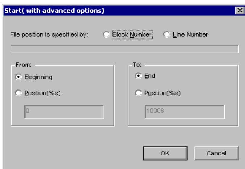
В этом окне оператор должен ввести номера начальной и конечной секций выполняемого участка программы обработки и щелкнуть мышью на кнопке OK. После этого станок начинает выполнение указанных секций программы.
