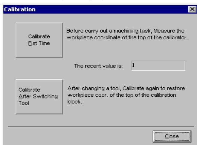
При выполнении настройки оператор должен определить высоту поверхности заготовки и установить соответствующее значение начала координат заготовки по оси Z. После этого необходимо выполнить первую настройку, а затем - вторую настройку после смены режущего инструмента. Следуйте указаниям, отображаемым в диалоговом окне.
