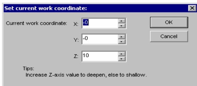
Введите допустимые значения координат по осям X, Y, Z в соответствующих полях диалогового окна - координаты текущего положения рабочего органа будут изменены соответствующим образом.
