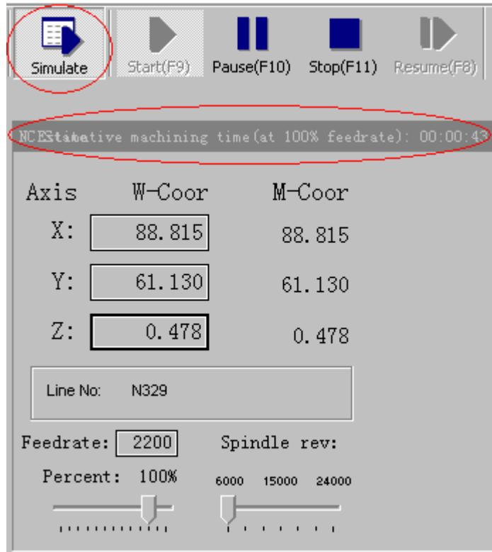
В строке заголовка вкладки NC state отображается также некоторая статусная информация. Например, на предыдущем рисунке показан вид вкладки в режиме имитации: в строке заголовка выводится название режима simulating mode, а в правой части строки заголовка выводится аппроксимированное значение продолжительности обработки (соответствующее скорости подачи 100%). В процессе нормальной работы в этой позиции выводится фактическая продолжительность обработки.
